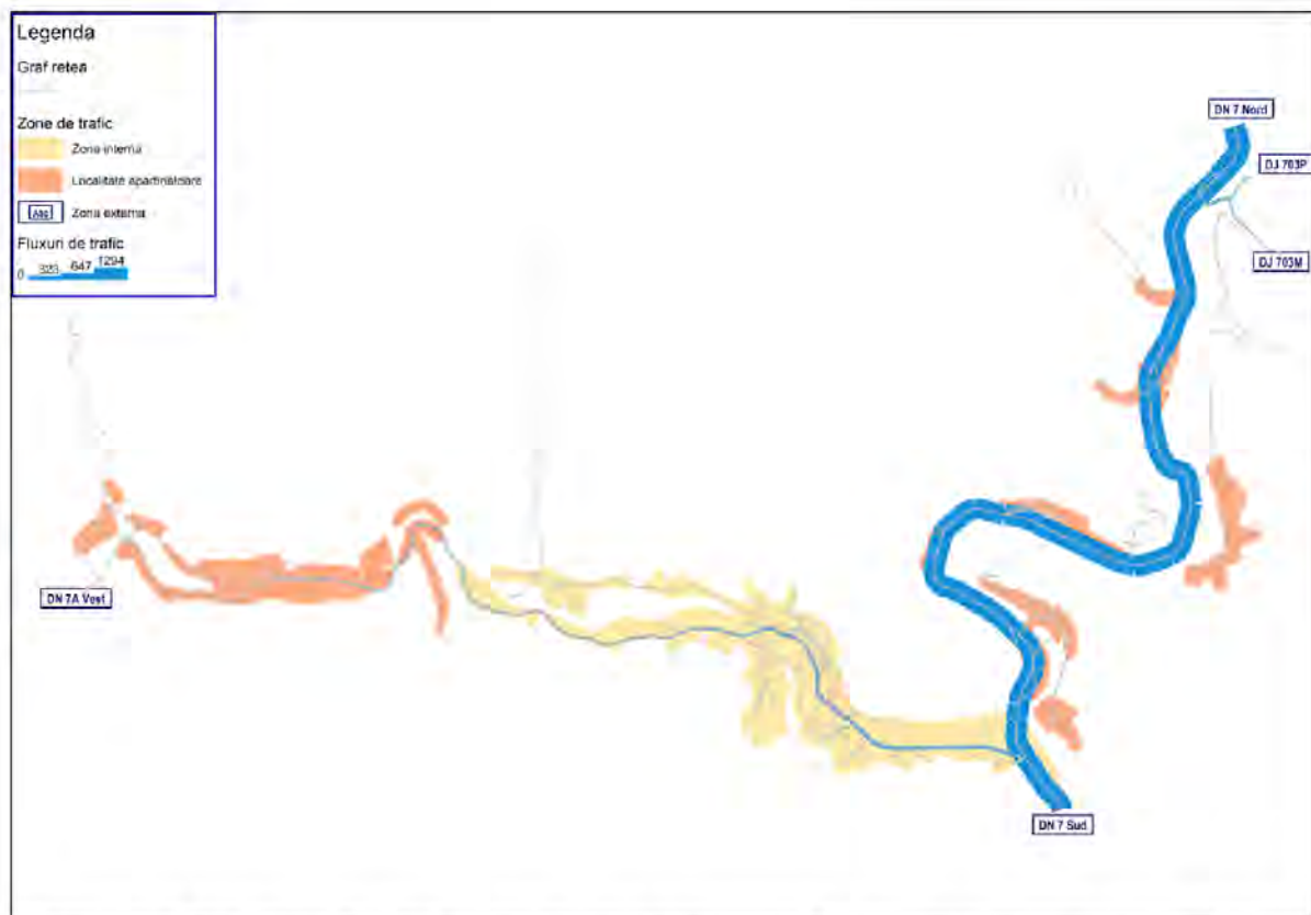
Figura 3.36. Fluxuri de trafic, vehicule etalon, Scenariul ANFN_ ora de vârf de trafic, 2027.
